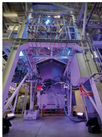
Reaktor, ve kterém probíhá plazmové zplyňování
