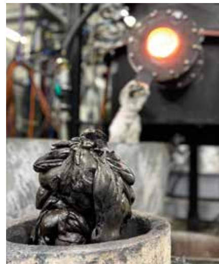
Inertní struska po vypuštění z reaktoru a vychladnutí
