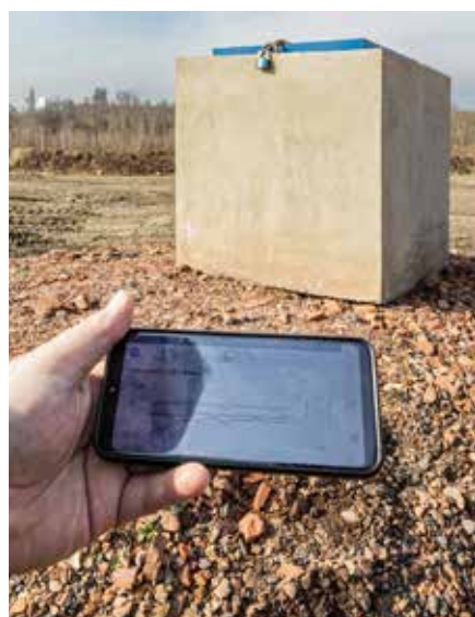
Kontinuální termický monitoring v oddělovací vzdušné stěně heřmanické haldy
