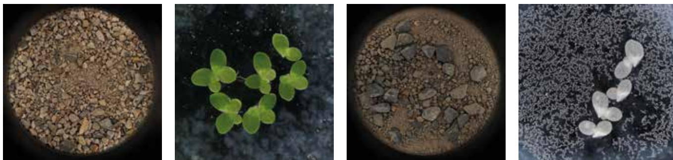
Obrázek 2: Drcený stavební a demoliční odpad a testování výluhů pomocí okřehku ( Lemna minor ). Vlevo betonový odpad z demolic obsahující zbytky zeminy a výsledek testu toxicity (netoxický vzorek). Vpravo odpadní beton s vysokým obsahem cementu a jeho letální účinky
