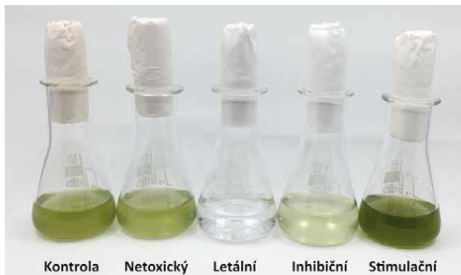
Obrázek 3: Ukázka akutního testu toxicity. Zcela vlevo je kontrola, dále testované vzorky s různými účinky. Intenzita zelené barvy je úměrná celkovému množství řas ve vzorku. Pro větší názornost byla hustota řas ve vzorcích větší, než bývá v rutinních testech toxicity obvyklé
